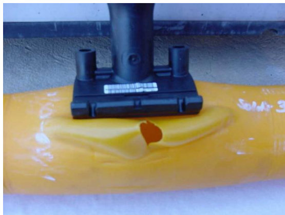
Rotura dúctil de la soldadura entre los filamentos del accesorio.
