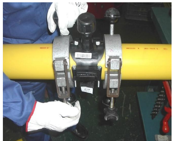
Figura 7.5. Montaje del accesorio y redondeadores
