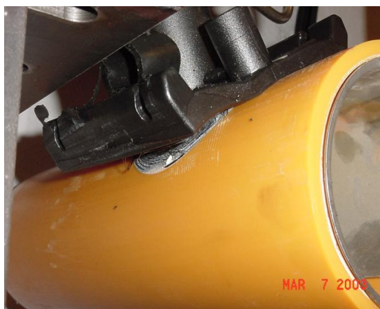
Resultado del ensayo. La T se ha roto antes de fallar la soldadura, ya que era correcta.
