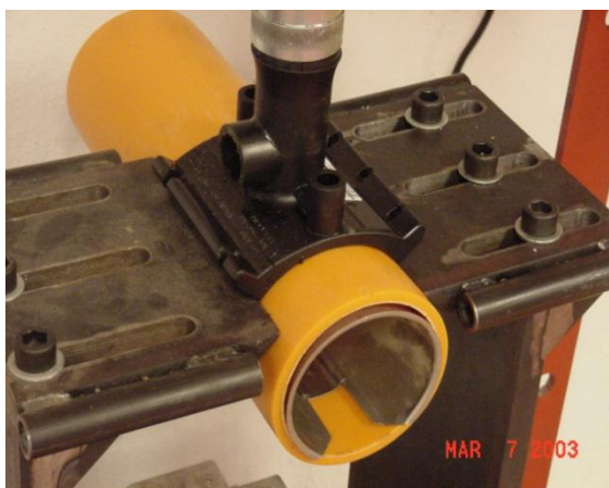
Probeta en la máquina de ensayo. En este caso, la fuerza se aplica desde arriba.
