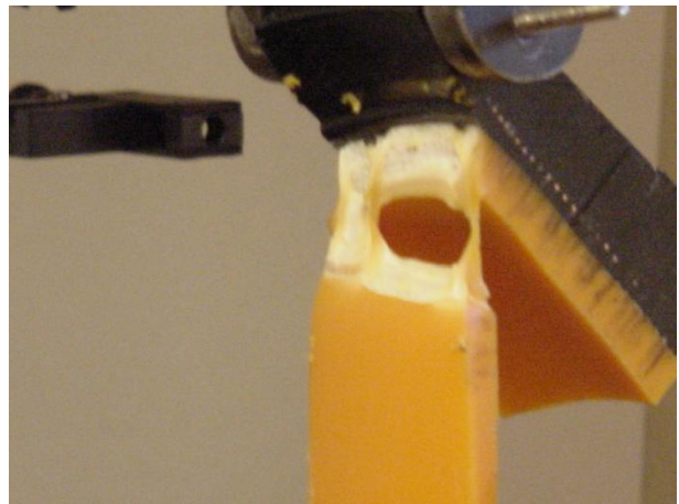
Rotura dúctil de la tubería al ser más débil que la soldadura.
