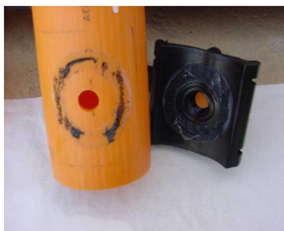
Resultado del ensayo cuando la soldadura ha sido hecha de forma incorrecta. Se puede observar que la mayor parte de la superficie se ha despegado limpiamente.
