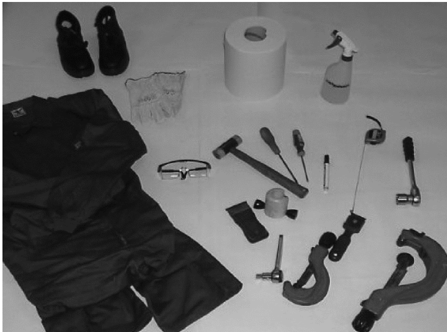
Figura 5.b. Útiles y herramientas para electrofusión
