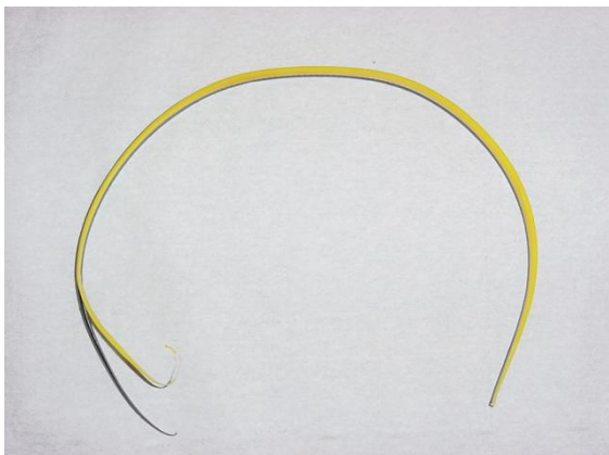
Cordón de soldadura entre tubería y accesorio de PE80.
