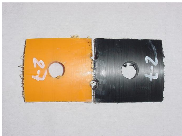
Probeta para prueba de tracción de soldadura a tope de una tubería y un accesorio PE100 PA-U . Para realizar el ensayo se elimina el cordón de soldadura.
