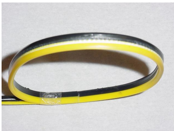
Cordón de soldadura entre tubería y accesorio de PE80. Al doblar el mismo, no se aprecia contaminación de la soldadura ni hendiduras de ningún tipo.
