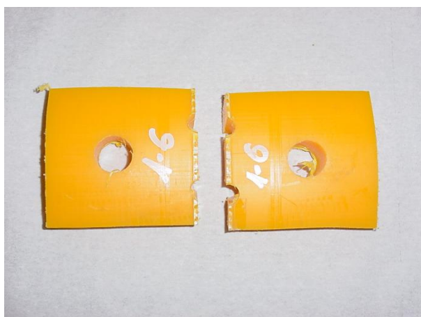
Probetas de soldadura de tubería PE100 PA-U . Se puede observar la rotura frágil de la soldadura.
