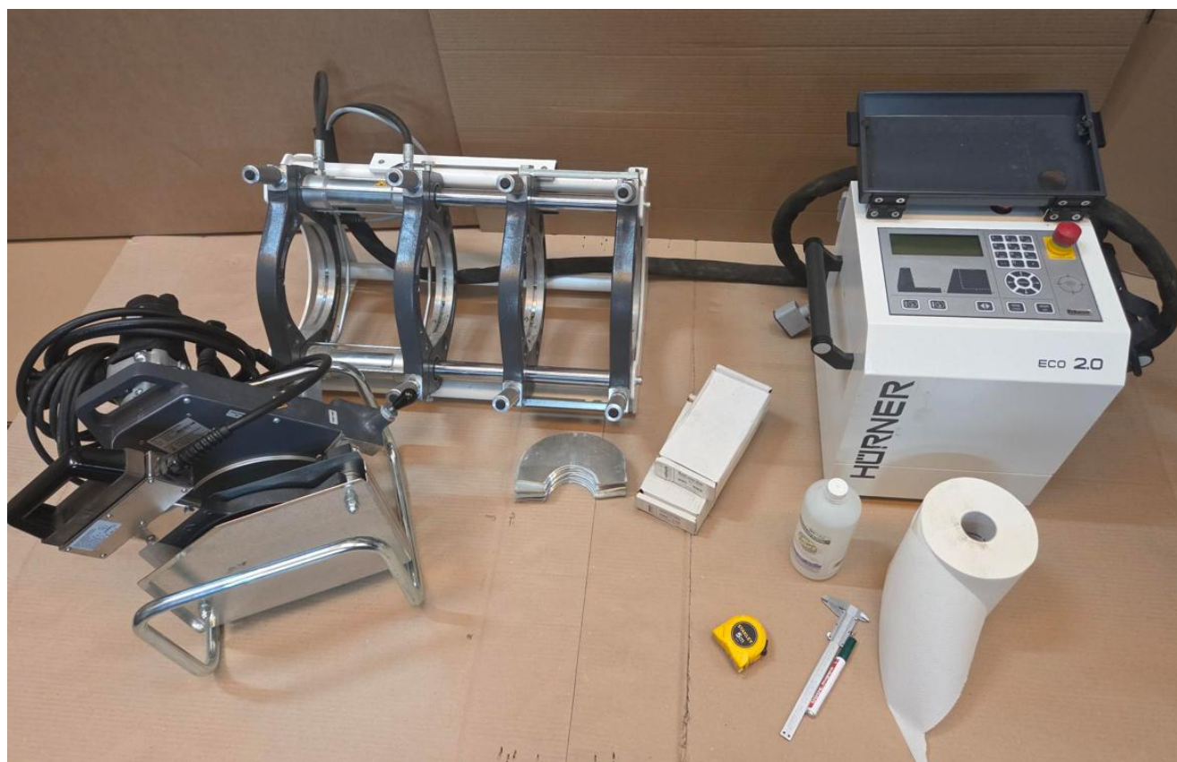
Figura 3. Máquinas y útiles para soldar a tope
