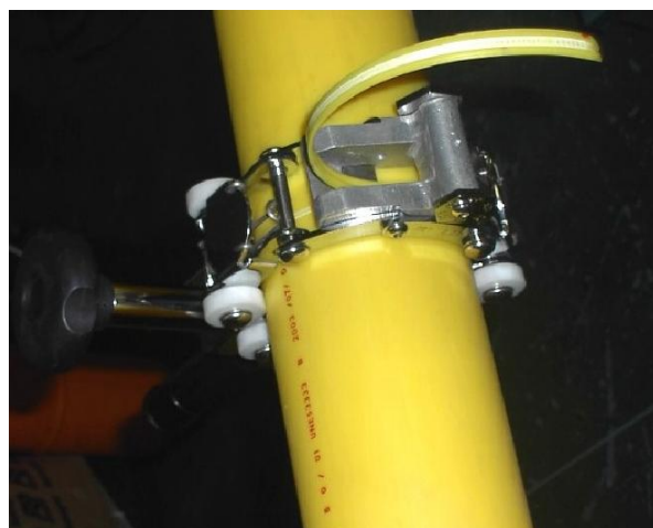
Figura 5. Retirada del cordón
