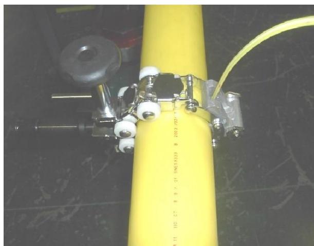
Figura 5. Retirada del cordón
