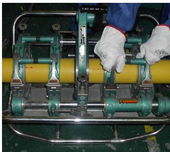
Figura 4.4. Inserción del refrentador
