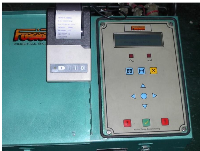
Figura 4.15. Impresión del resultado de la fusión
