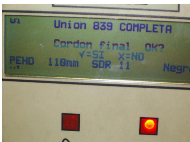
Figura 4.14. Comprobación de la soldadura
