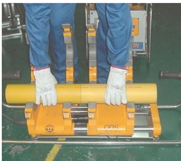
Figura 4.2. Posicionado de los tubos
