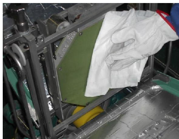
Figura 4.10. Limpieza de la placa calefactora
