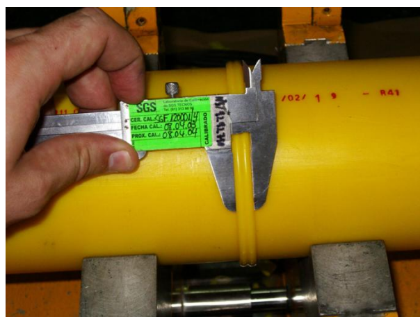
Figura 4.14. Comprobación de la soldadura
