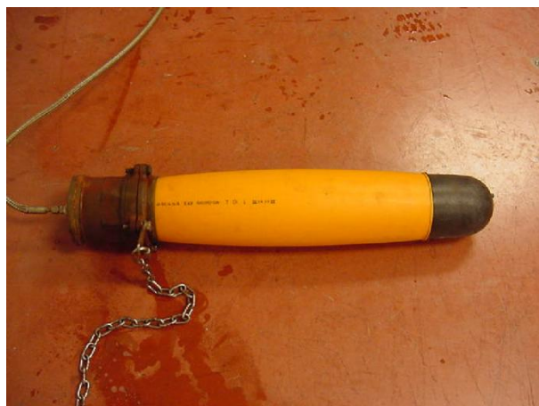
Probeta para comprobar la soldadura a tope de una tubería PE100, SDR17,6 y un tapón PE100, después de una prueba de 165 horas a 80 °C, con una presión interna de 6,6 bar (5,5 MPa).
