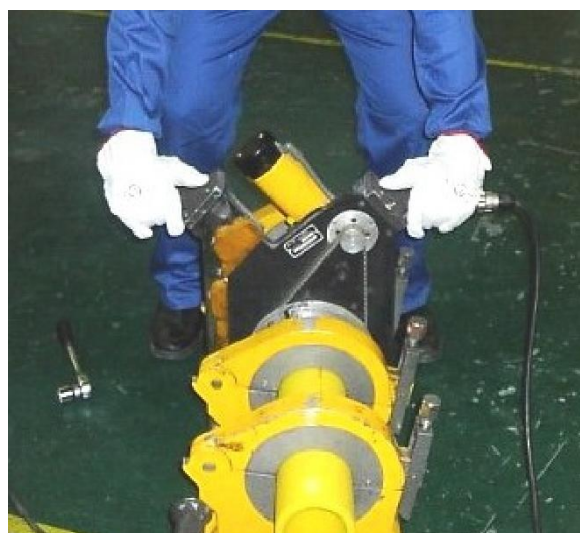
Figura 4.4. Inserción del refrentador
