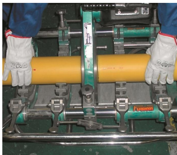
Figura 4.2. Posicionado de los tubos
