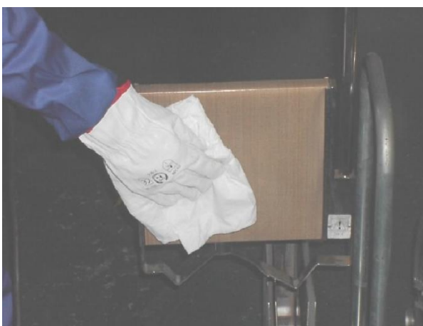
Figura 4.10. Limpieza de la placa calefactora
