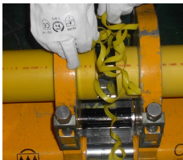
Figura 4.6. Retirada de las virutas producidas
