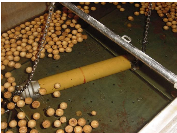
Probeta para comprobar la soldadura a tope de una tubería PE100, DN110, SDR17,6, dentro de un baño termostático.
